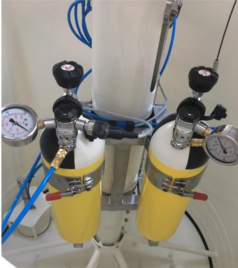
Die Pressluftflaschen gestatten mehr als 200 Öffnungszyklen mit großem Hub (Öffnen und Schließen) oder mehr als 600 Öffnungszyklen mit kleinem Hub (Öffnen und Schließen).
